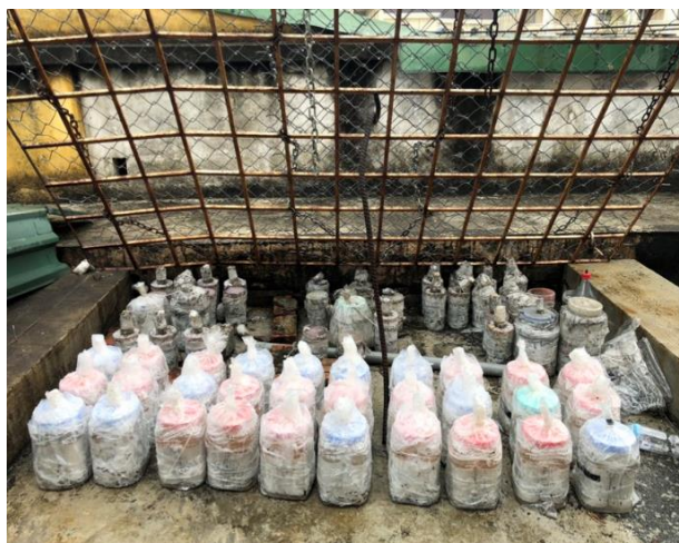
Hình 2.5. Ảnh chụp mẫu được thủy hóa ở điều kiện nhiệt độ ngoài trời
