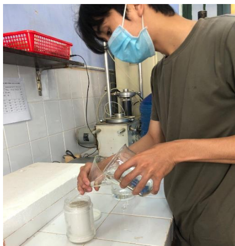
Hình 2.4. Ảnh chụp mẫu khi cho nước biển vào hộp đựng mẫu
